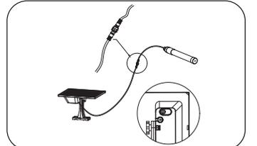
④ Csatlakoztatás: dugja be az aljzatot és a dugaszt, és húzza meg a vízálló anyákat. Az összeszerelés után ellenőrizze, hogy megfelelő-e a rögzítés. Nyomja meg a tápegység hátoldalán található kapcsolót, és távolítsa el a távezérlő végén lévő PVC távtartót a lámpatest működési módjának vezérléséhez.
