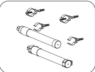
③ Praticare un foro nella posizione di installazione (la distanza tra i fori è di 200 mm). Inserire una vite nel foro in posizione, quindi fissare il tubo T8 alla parete con una vite autofilettante e fissare il tubo nel gancio
