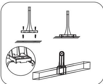
② Bohren Sie ein Loch an der Montageposition (entsprechend dem Abstand zwischen den Löchern der Halterung an der Montageposition). Setzen Sie die fischförmigen Dübel in die Löcher ein, schlagen Sie sie ein und montieren Sie die Halterung mit selbstschneidenden Schrauben oder binden Sie die Halterung an der Montageposition mit einem Band fest.
