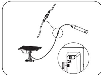
④ Raccordement : branchez les fiches mâle et femelle et serrez les écrous étanches. Après l'installation, sécurisez l'installation. Appuyez sur l'interrupteur à l'arrière du boîtier d'alimentation et retirez l'entretoise en PVC à l'extrémité de la télécommande pour contrôler le luminaire.
