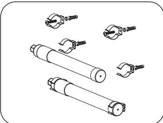
③ Faça um orifício na posição de instalação (distância de 200 mm entre os orifícios). Coloque um plugue de parafuso em forma de peixe no orifício e bata-o no lugar, depois fixe o tubo T8 na parede com um parafuso auto-tocador e prenda o tubo no clipe.
