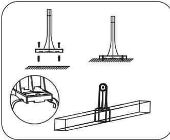
① Praticare un foro nella posizione di installazione (in base alla distanza tra i fori della staffa). Inserire i tappi a vite nei fori in posizione, quindi installare la staffa con viti autofilettanti; oppure legare la staffa nella posizione di installazione con una fascetta.
