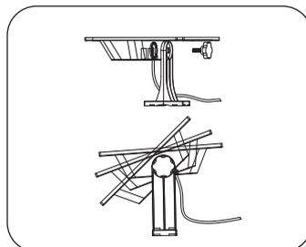
② Fije el módulo de almacenamiento de energía en el soporte con un tornillo. Ajuste el ángulo: la cara del panel fotovoltaico debe estar 5-10 grados Oeste a Sur y con cierto ángulo respecto al plano horizontal (30 grados Sur, 45 grados Norte), luego gírelo con fuerza.
