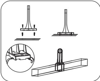
① Faites un trou à la position d'installation (en prenant bien en compte la distance entre les trous du support). Insérez les chevilles à vis dans les trous et enfoncez-les. Installez ensuite le support avec des vis autotaraudeuses ou attachez le support avec une attache.
