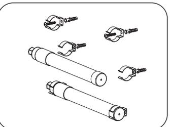
③ Haga un agujero en la posición de instalación (200 mm de distancia entre agujeros). Inserte los tapones roscados con forma de pez en el orificio, golpéelos hasta que encajen en su sitio, a continuación, fije el tubo T8 a la pared con un tornillo autorroscante y sujete el tubo en el clip.
