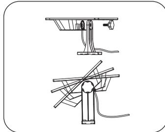
② Fixez le module de stockage d'énergie sur le support avec une vis à main. Ajustez l'angle : la face du panneau photovoltaïque d'environ 5-10 degrés d'ouest en sud et à un certain angle par rapport à l'horizontale (30 degrés au sud, 45 degrés au nord) et tournez-le fermement.
