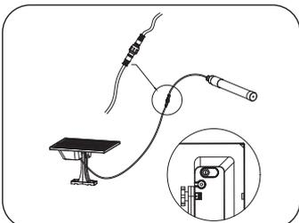
④ Conexión: enchufe los conectores macho y hembra y apriete las tuercas. Comprobación después de la instalación: asegure la instalación. Pulse el interruptor de la parte posterior de la caja de alimentación y retire el espaciador de PVC del extremo del mando a distancia para controlar el modo de funcionamiento de la luminaria.
