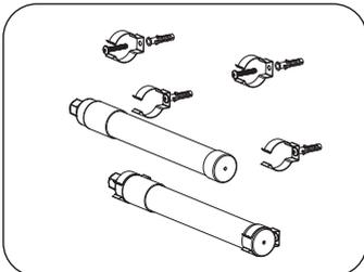
③ Faites un trou à la position d'installation (distance de 200 mm entre les trous). Mettez une cheville à vis dans le trou et enfoncez-la. Fixez ensuite le tube T8 au mur avec une vis autotaraudeuse et fixez le tube dans le clip.
