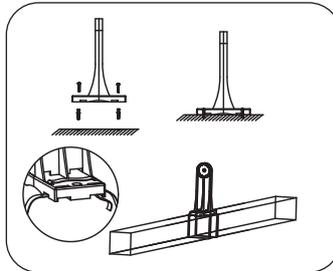
① Faça um orifício na posição de instalação (de acordo com a distância entre os orifícios do suporte na posição de instalação). Insira os parafusos em forma de peixe nos orifícios e bata-os no lugar e instale o suporte com parafusos auto-toques; ou amarre o suporte na posição de instalação com uma gravata.
