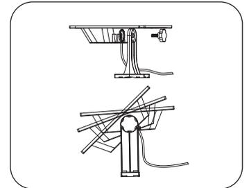
② Corrija o módulo de armazenamento de energia no suporte com um parafuso manualmente. Ajuste o ângulo: a face do painel fotovoltaico em direção a 5 a 10 graus a oeste a sul e em um certo ângulo na horizontal (30 graus no sul, 45 graus no norte) e torne-o firmemente.
