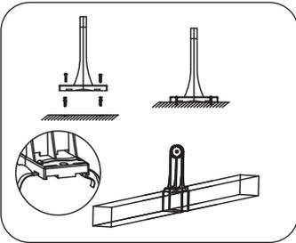
① Wykonaj otwór w miejscu montażu (zgodnie z odległością między otworami wspornika). Włóż kolek rozporowy do otworów i wbij do końca, a następnie zamontuj wspornik za pomocą wkrętów samowiertujących; lub zwiąż wspornik opaską w pozycji montażowej.
