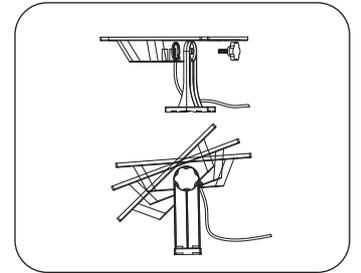
② Fissare manualmente il pannello solare sulla staffa con una vite. Regolare l'angolo in modo che la superficie del pannello fotovoltaico sia inclinata verso sud-ovest di 5-10 gradi e ad un certo angolo rispetto alla linea della meridiana. (30 gradi a sud, 45 gradi a nord) e ruotarlo saldamente.
