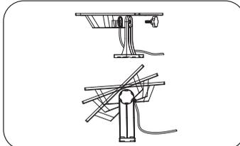
② Rögzítse az energiatároló modult a konzolhoz, kézzel hajtsa be a csavart. Állítsa be a szögét: a fotovoltaius panel előlapját 5-10 fokkal nyugat-dél felé, a vízszinteshez képest bizonyos szögben (30 fok délre, 45 fok északra), és szorosan húzza meg.
