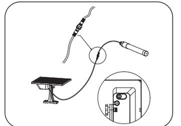
④ Collegamento: inserire le spine maschio e femmina e serrare i dadi impermeabili. Controllare il fissaggio dopo l'installazione. Premere l'interruttore sul retro della scatola di alimentazione e rimuovere il distanziatore in PVC all'estremità del telecomando per controllare la modalità di funzionamento dell'apparecchio.
