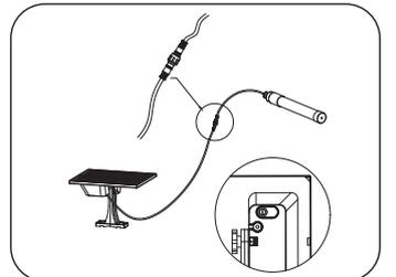
④ Conexão: Conecte os tampões masculinos e femininos e aperte as nozes à prova d'água. Verifique após a instalação: prenda a instalação. Pressione o interruptor na parte traseira da caixa de energia e remova o espaçador de PVC no final do controle remoto para controlar o modo de trabalho da luminária.
