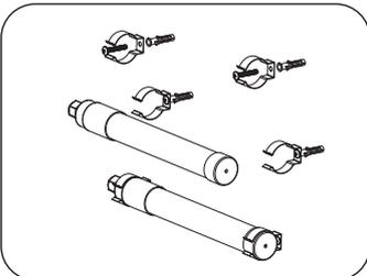
③ Wykonaj otwór w miejscu montażu (odległość między otworami 200mm). W otwór włóż kolek rozporowy i wbij go do końca, następnie przymocuj rurę T8 do ściany za pomocą wkrętu samowiertującego i zamocuj rurę w zaczepleniu.
