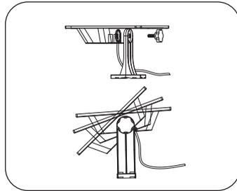
② Zamocuj ręcznie panel słoneczny na wsporniku za pomocą śruby. Wyreguluj kąt: przód panelu fotowoltaicznego w kierunku 5-10 stopni z zachodu na południe i pod odpowiednim kątem do poziomu (30 stopni na południe, 45 stopni na północ) i mocno go skręć.
