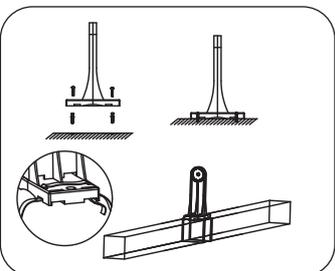
① Haga un orificio en base a la posición de instalación (de acuerdo con la distancia entre los orificios del soporte en la posición de instalación). Inserte los tapones roscados con forma de pez en el orificio, golpéelos hasta que encajen en su sitio y monte el cuerpo de la lámpara con el tornillo autorroscante o sujételo en la posición de instalación con una brida.
