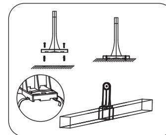
② Maak gaten op de installatiepositie (volgens dezelfde afstand als de gaten van de beugel). Steek de schroefpluggen met weerhaken in de gaten en klop ze op hun plaats, en installeer de beugel met zelftappende schroeven; of bind de beugel op de installatiepositie vast met een band.
