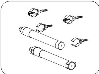
③ Bohren Sie ein Loch an der Installationsposition (200 mm Abstand zwischen den Löchern). Stecken Sie einen fischförmigen Dübel in das Loch und schlagen Sie ihn ein, dann befestigen Sie das T8-Rohr mit einer selbstschneidenden Schraube an der Wand und befestigen das Rohr in der Schelle.
