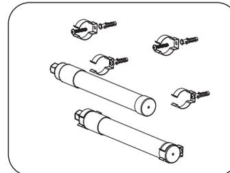
③ Maak gaten ter hoogte van de installatiepositie (200 mm afstand tussen de gaten). Plaats schroefpluggen met weergaten in het gat en klop deze op zijn plaats, bevestig vervolgens de T8-buis aan de muur met zelftappende schroeven en bevestig de buis in de clip.
