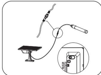
④ Podłączenie: podłącz wtyczki męskie i żeńskie i dokręć nakrętki wodoodporne. Sprawdź i zabezpiecz po zainstalowaniu Naciśnij przełącznik z tyłu skrzynki zasilającej i usuń przekładkę z PCV na końcu pilota, aby sterować trybem pracy oświetlenia.
