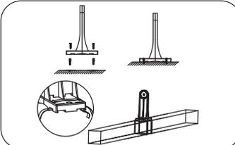
① Készítsen egy furatot a felszerelés helyén (a konzolon található lyukak közötti távolságnak megfelelően a felszerelés helyén). Helyezze be a hal alakú csavaros dugókat a furatokba, üsse be őket a helyükre, szerelje fel az univerzális konzolt önmetsző csavarokkal, vagy rögzítse a konzolt a felszerelés helyére kábelköteggel.
