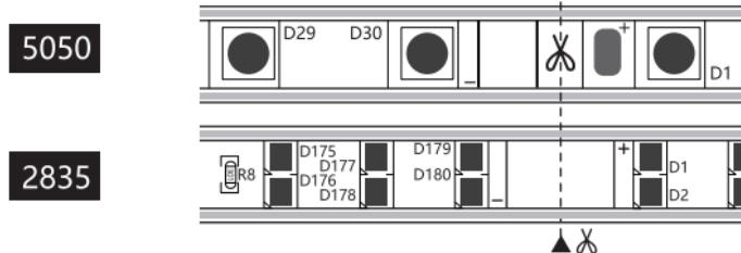
Schneiden Sie den Streifen auf die Länge, die Sie der Markierung entnehmen können (oder dem Platz zwischen jedem Meter); Manchmal sind die Streifen nicht genau in Einheit mit der Marke, es muss aber einen offensichtlichen Abstand haben, der breiter als andere Punkte ist.
