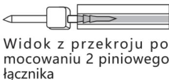
Widok z przekroju po mocowaniu 2 pinowego łącznika
