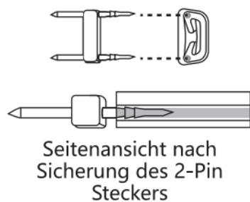
Seitenansicht nach Sicherung des 2-Pin Steckers
