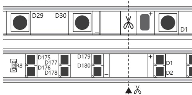
Ao cortar a tira até o comprimento que precisa da marca de corte aqui (ou do espaço entre cada 1 metro);
