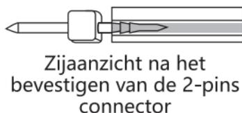
Zijaanzicht na het bevestigen van de 2-pins connector
