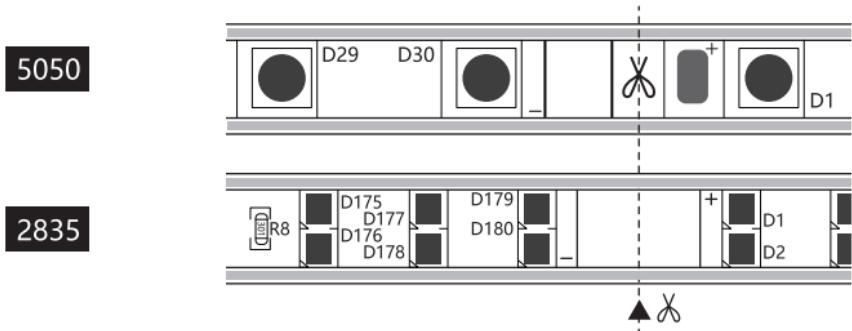
A fénysor itt jelzett vágási jelzésnél (vagy a méterenként kialakított üres résznél) történő, szükséges hosszra vágáskor előfordulhat, hogy a fénysoron nincs vágási jelzés kialakítva, azonban többi pontnál szélesebb üres rész egyértelműen jelzi a vágás helyét.
