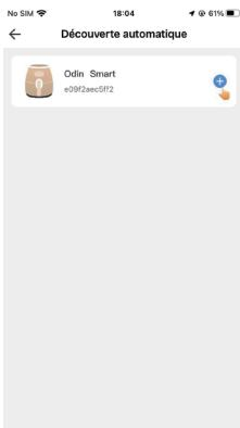
Sur l'interface de recherche automatique, cliquez sur le «+» sur le côté droit de l'appareil, entrez le mot de passe Wi-Fi correct et attendez que l'appareil se connecte avec succès au réseau.
