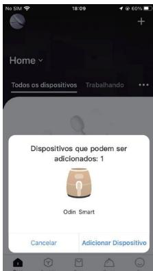
Certifique-se de que o dispositivo esteja ligado, abra a APP AigoSmart e clique em "Adicionar Dispositivo" na janela pop-up para adicionar um dispositivo. Se o dispositivo não for encontrado após abrir a APP por um tempo, clique no botão "+" no canto superior direito para descobrir o dispositivo.
