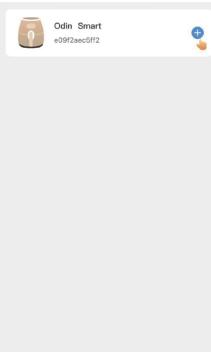
Na interface de descoberta automática, clique em "+" no lado direito do dispositivo, digite a senha Wi-Fi correta e aguarde até que o dispositivo se conecte à rede com sucesso.
