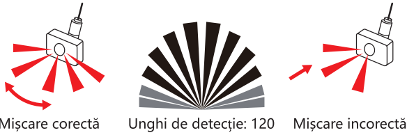
Mișcare corectă Unghi de detecție: 120 Mișcare incorectă
