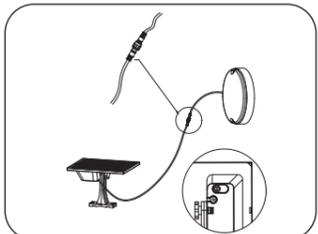
④Anschluss: Stecken Sie die Stecker und Buchsen ein und ziehen Sie die wasserdichten Mutttern fest. Kontrolle nach der Installation: Sichern Sie die Installation. Drücken Sie den Schalter auf der Rückseite des Schaltkastens und entfernen Sie den PVC-Abstandhalter am Ende der Fernbedienung, um den Betriebsmodus der Leuchte zu steuern.
